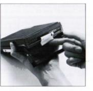
A. 連光カバーを引き抜いてしまっても白タブが出ないときは、直射日 光を避けて、日陰か室内で、裏蓋を わずかに開け、フイルムバックを動 かさずに、白タブの端を外側に出し ます。 A. If there is nowhite tab sticking out, after removing the safety cover, this must be corrected before proceeding any further. The correction should be made in the shade or indoors and not in direct sunlight.
