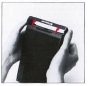
C. ロックレバーの両端を矢印の方向に動かし、裏蓋を開きます。フイルムを入れる前に、必ず引蓋を完全に挿入しておいてください。
