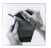
G. 指定の現像時間がすみましたら、 黒色の紙(撮影枚数の数字に近い隅) から写真をはがします。カラー写真 は表面がほとんど乾いているように 見えますが、数分間は指などで触れ ないでください。 G. After the recommended development time, quickly strip the white paper (print) off the brown paper, starting from the corner with the exposure number. Although the color print will appear to be nearly dry, do not touch it for a few minutes. When completely dried, mount it on a color print mount.
