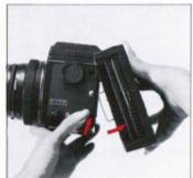
B. カメラボデイの着脱ボタンを押すと、ボラロイドバックEは、下方から矢印の方向にはずれます。
