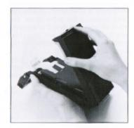
C. タイプ87、88フイルムを使用したときの操作は前項「フイルムパックの装塡」で説明したように、マイルムは裏蓋に押されて固定してるといって、裏蓋を開けるとフィルムがはずれないように、必ずフィルム面が下にくるような向き、まった時いでください。このとき、フィルムパックが枠より浮き上がらないよう指で押えて操作してください。
