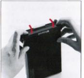
B. 白タブがスリットから出ている ままで、裏蓋をもとどおり両側でし っかり押しつけて閉め、ロックレバ ーでロックしてください。 B. Close the front plate securely, by pressing on both sides strongly, with the white tab sticking out of the small slot, and fix the lock lever securely.
