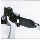
E. 黄タブをポラロイドバック Eから、まっすぐ静かに引き出します。 黄タブを引き出しきったときから現像が始まります。引き出す早さはどのくらいかと言えば「引き出す」とで普通の早さで言う時間ぐらいです。写真に無数の白色斑点が出るらであれば引き出しかたが早いからで、もう少しゆっくりします。 E. Pull the yellow tab straight, moderately fast, in one smooth uninterruped action. Development starts when the yellow tab has been pulled completely out and, therefore, start timing development from that point. If the developed print is full of white specks, slow down a little as you are pulling too fast.
