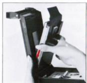
D. 前板をいっぱいに開けます。フ イルムパックの両側を持ち、遮光カ バーの印刷面 (フイルム面) を外側 に向けて、先端をガイドにつきあて 矢印方向に押し込みます。 D. Open the front plate all the way. Next, hold the pack film by the edges, with the printed surface of the safety cover (film face) towards the camera, place the pack film to the guide and push down in the arrow-indicated direction.
